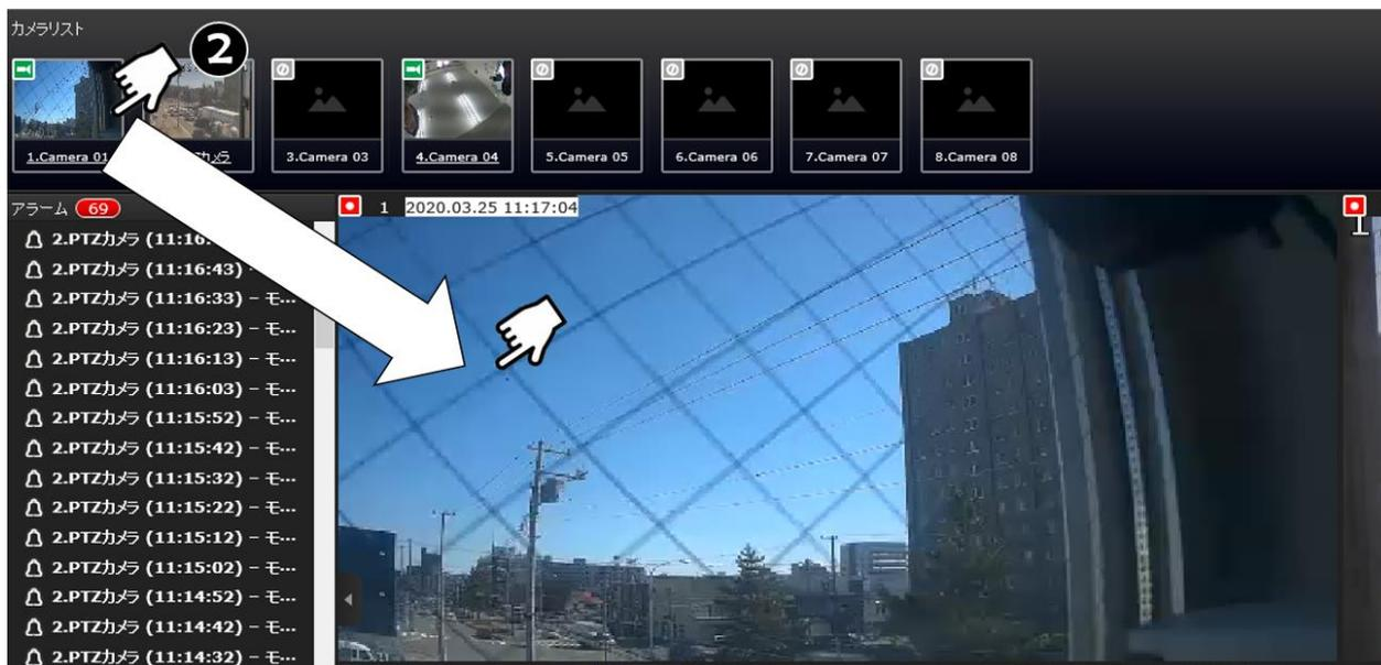
3. 現在のレイアウト（たとえば6台のカメラ）を1M + 5レイアウトに配置したら、ページ切り替えボタン「**1**」をクリックして、次のレイアウトページに進みます。
