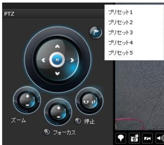
プリセットボタンを使用してプリセットポジションを表示し、カメラをプリセット方向に移動させます。カメラツアーを実行し、連続してポジション移動できます。
