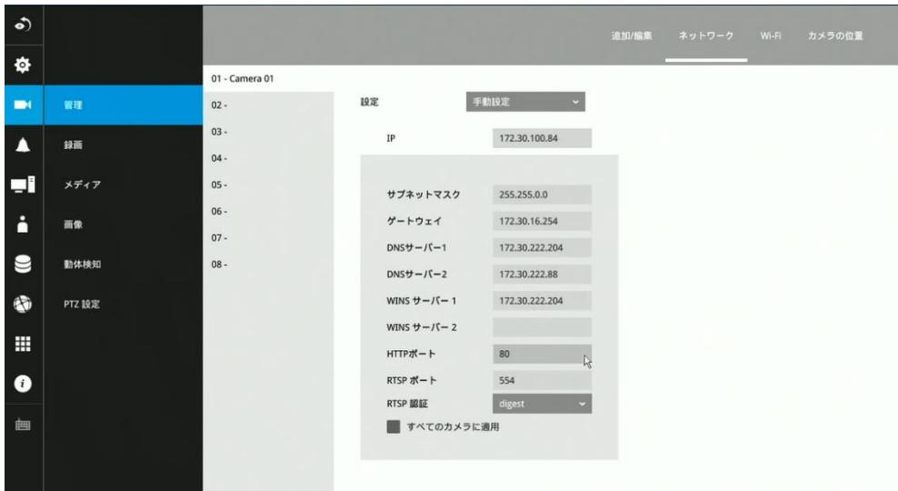
カメラがIPアドレスを取得する方法としてDHCPを選択するか、固定IPアドレスを選択するかを単一のカメラまたはすべてのカメラに同時に設定できます。通常は固定IPアドレスを使用することをお勧めします。NVRはカメラのMACアドレスを記憶できますが、DHCP設定でIPアドレスが変更されると、NVRがカメラの接続に失敗する場合があります。ネットワーク設定の詳細については、ネットワーク管理者に相談してください。通常、ネットワーク環境に競合がない限り、HTTPポートとRTSPポートのポート番号を変更する必要はありません。
