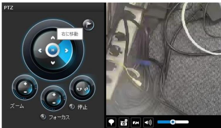
プリセットポジションとパトロール機能には、Webコンソールでのカメラの関連設定が必要です。これらの機能を使用する前に、カメラのあるWebコンソールでプリセットポジションを設定する必要があります。NVR GUIは、PTZプリセットポジションの設定オプションを提供しません。
