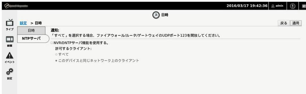
NVR の NTP サーバ機能を有効にすると、他のデバイス（カメラ、PC、他 NVR）の時刻を NVR と同期することができます。
