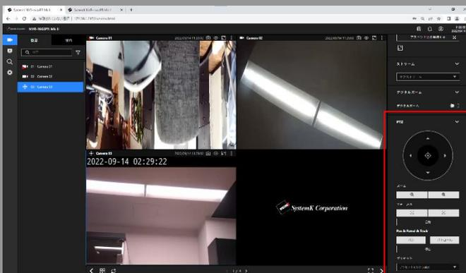
カメラにPTZ機能がついているカメラはこのボタンからカメラの遠隔操作ができます。
