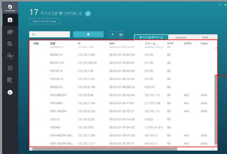
デスクトップ上の Device Manager をダブルクリックすると設定可能な NVR が選択できます。管理したい NVR をダブルクリックするとログイン画面が表示されます。
