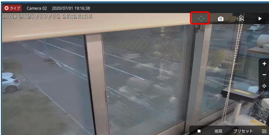
PTZ カメラの映像の上にマウスを移動し、PTZ アイコンをクリックして有効化します。
